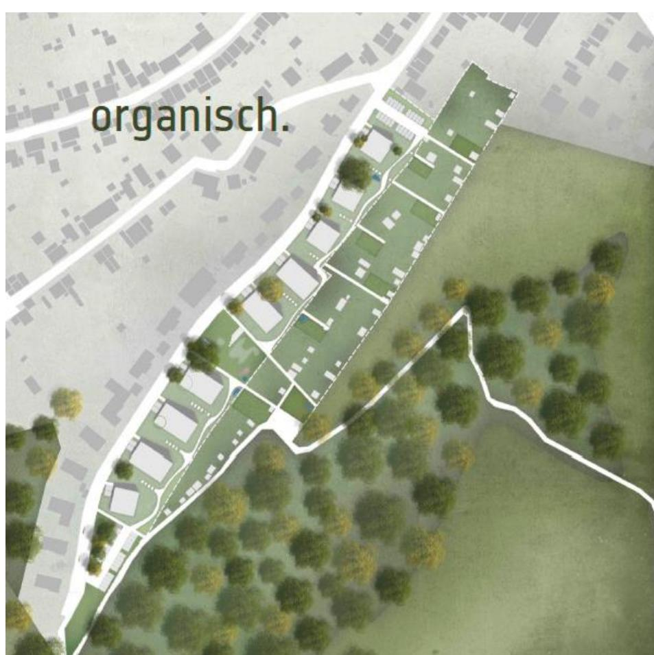
Das Entwurfskonzept basiert auf insgesamt neun Häusern, die wie an einer Perlenkette, organisch entlang der Elmenhorststraße, aufgereiht werden. Vier Punkthäuser und fünf Zeilenhäuser werden unter Berücksichtigung der besonderen Topographie orthogonal zur Straße angeordnet. Zur Straßenseite ergibt sich ein 3-geschossiger Baukörper, der durch das abfallende Gelände auf der Gartenseite eine 4-Geschossigkeit aufweist.
