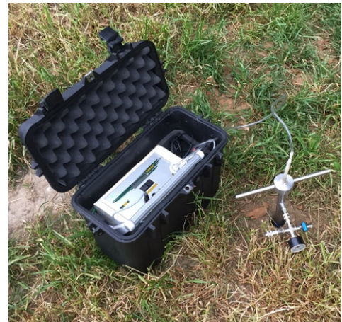
Abb. 3: Packersonde mit Radonmonitor
