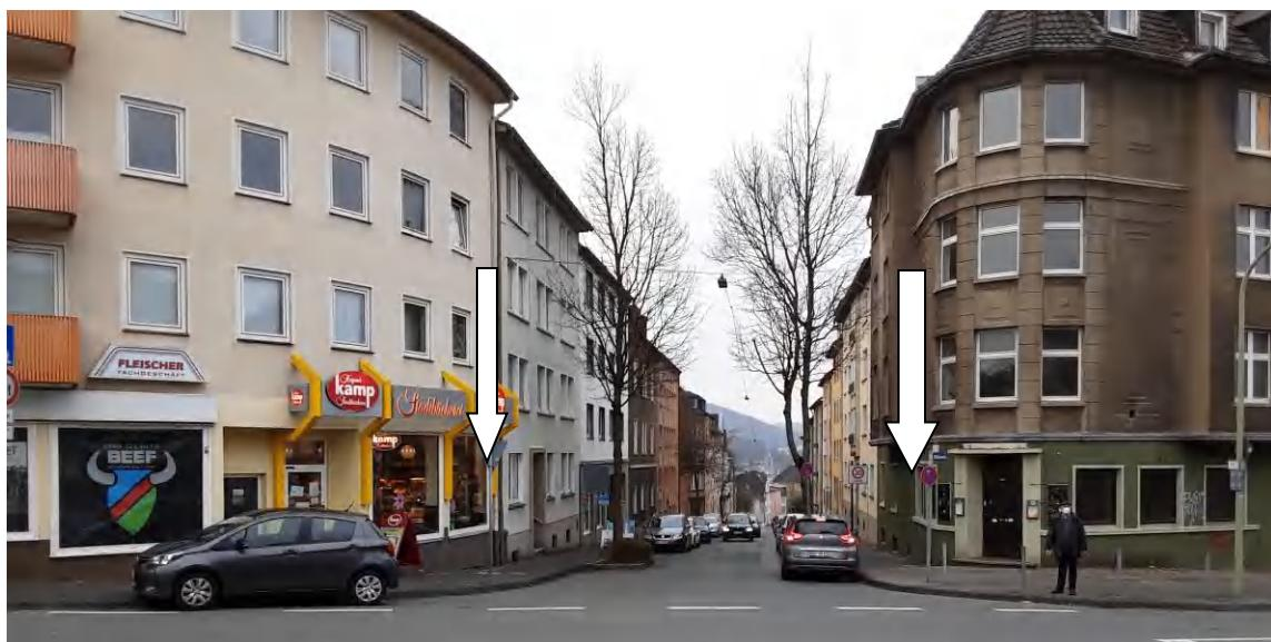
Oberhalb der Bülowstraße ist ebenfalls die Fahrbahnmarkierung entsprechend der neuen Verkehrsregelung zu ändern. Z.214-10 ist zu entfernen. Z.214-30 (nach links und rechts) ist zu markieren.
