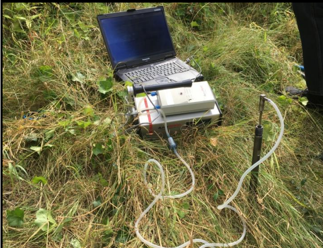
F3: Durchführung der Rn-222-Messung
