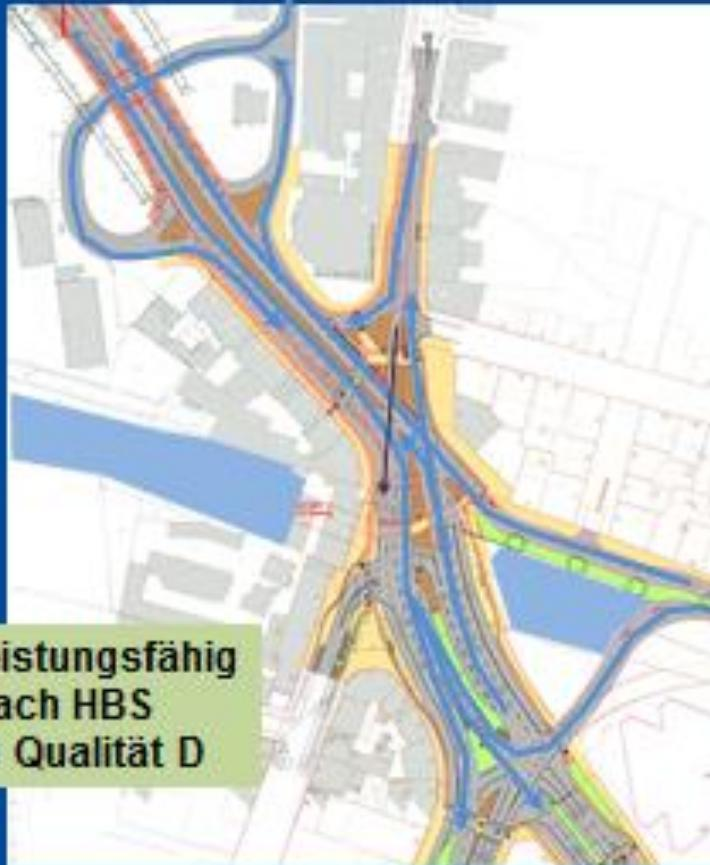
Eine direkte Führung der Geradeausverkehre der B54 in Richtung Innenstadt ist aus Gründen der Leistungsfähigkeit nicht möglich
