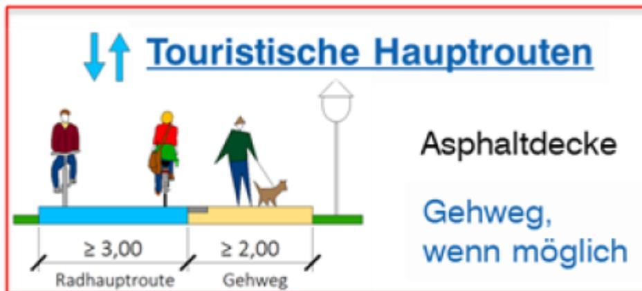
Wegen der Konflikte zwischen Fußgängern und Radfahrern ist sogar eine deutliche, bauliche Trennung zwischen Fuß- und Radweg sinnvoll. Hier kann ein Trennstreifen von min. 1,00 m ausgebildet werden, der mit niedrigem Bewuchs bepflanzt werden kann.
