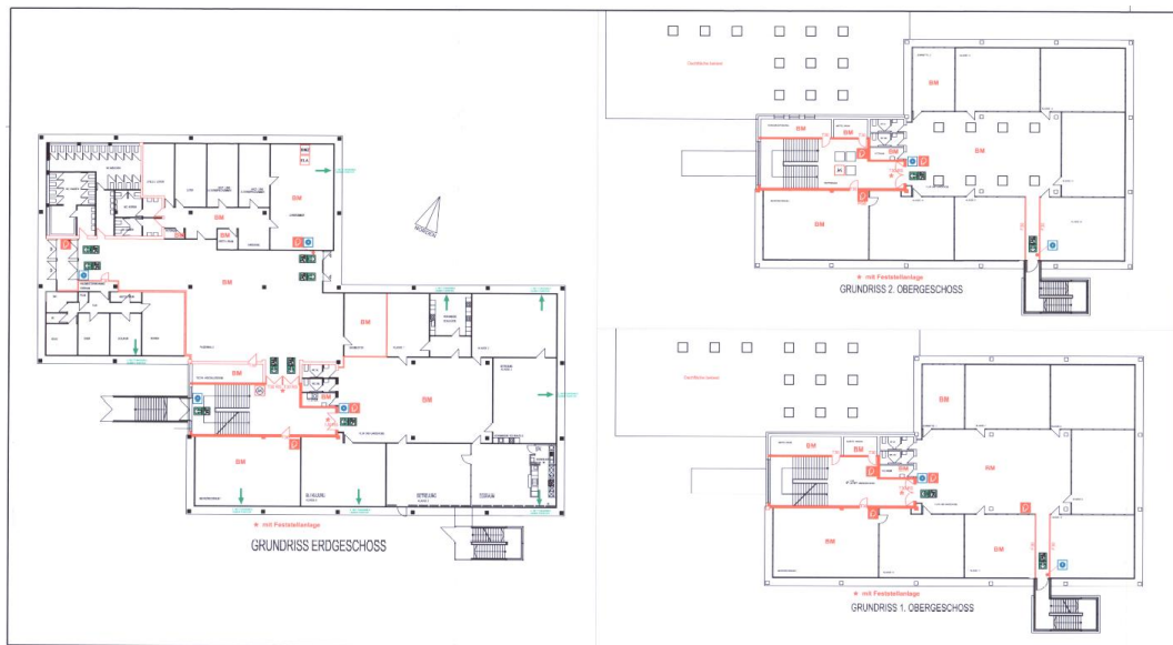
Abb. 8: Grundrisse aus dem Brandschutzkonzept (Stand 2005, mit Fluchttreppe)
