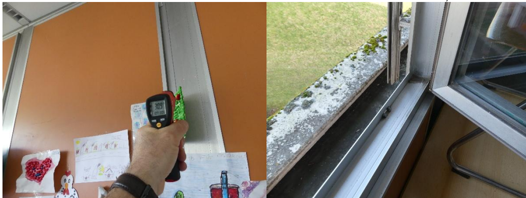
Extreme Aufheizung der Profile bereits gegen 10h morgens in gemäßigttem Aprilklima
